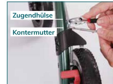
Kontermutter mit Gabelschlüssel Größe 8 lockern und komplett nach oben drehen. Die Zugendhülse gleichzeitig fixieren.
