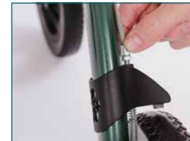
Stellen Sie die Bremskraft ein, indem Sie die Zugendhülse mit oder gegen den Uhrzeigersinn drehen. Kontrollieren Sie die Bremsfunktion, indem Sie die Räder drehen und die Bremsgriffe betätigen. Die Räder sollten frei drehen, aber beim Bremsen sofort stoppen. Bei festgestellter Bremse dürfen sich die Räder nicht bewegen lassen. Ziehen Sie die Kontermutter wieder fest an.
