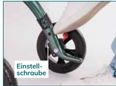
Die Nutzung der Schleifbremse empfiehlt sich bei leichtem Gefälle oder bei Menschen mit stark eingeschränktem Schrittempo. Betätigen Sie den roten Kipphebel, um die Schleifbremse zu aktivieren. An der Einstellschraube können Sie den Rollwiderstand einstellen.
