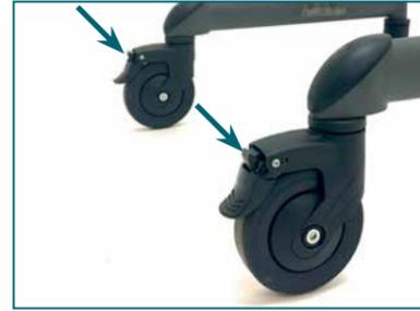
Um die Richtungsarretierung zu lösen, müssen Sie den mittig liegenden Arretierungshebel betätigen.
