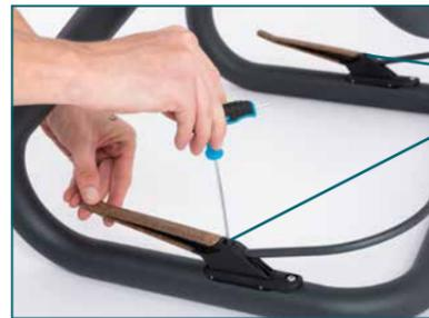
Drehen Sie den Wohnraumrollator um und stellen Sie ihn auf den Handlauf. Drehen Sie nun die Schrauben an beiden Handgriffen mit einem Inbusschlüssel Größe 3 mm heraus.
