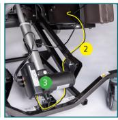
j) Kabel (2), welches aus der Kontrollbox (3) kommt wie im Bild gezeigt, verlegen.
