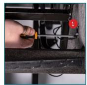
i) Fixierungsschraube wieder am Kabel (1) anbringen. (s. Schritt e)
