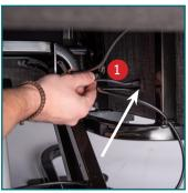
g) Kabel (1) durch die Öffnung im Stoff ziehen.
