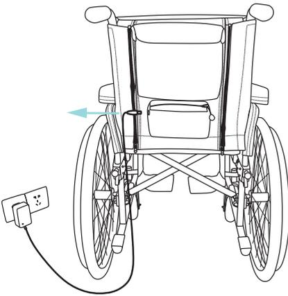
Leuchtet das Licht des Akkus grün, dürfen Sie das Ladekabel vom Akku trennen. Ziehen Sie das Netzteil aus der Steckdose und dem Akku. Jetzt sind keine Kabel mehr im Weg und Sie können sich frei mit der Heizung bewegen.
