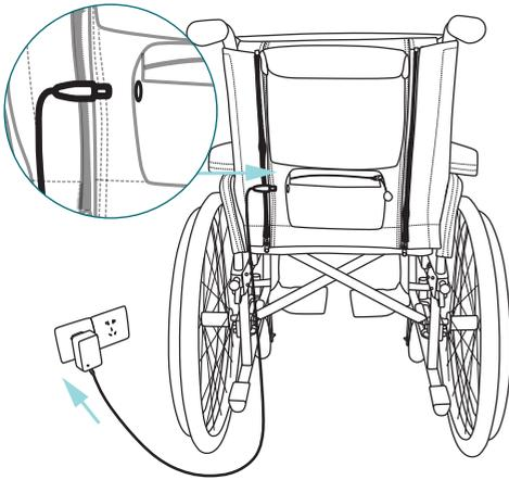
Am Anfang laden Sie den Akku vollständig auf! Benutzen Sie hierzu das Ladekabel. In der Akku-Tasche ist links ein seitliches Loch. Hier können Sie das Ladekabel direkt mit dem Akku verbinden. Dann stecken Sie das Netzteil einfach in die Steckdose.
