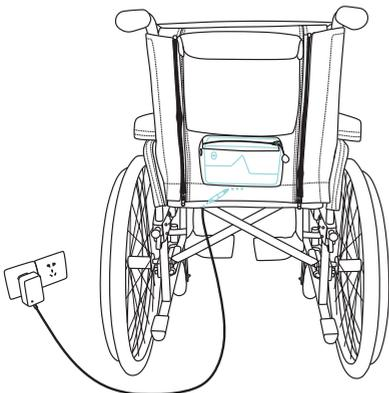
Auch der direkte Netzbetrieb ist möglich. Die Länge des Kabels beträgt einen Meter. Wir empfehlen aber, den Rollstuhl nicht zu bewegen, solange die Heizung direkt am Netz angeschlossen ist. Gehen Sie dazu genau wie beim Laden des Akkus vor und stecken das Ladekabel in den Akku. Die Heizung läuft nun automatisch für 60 Minuten.
