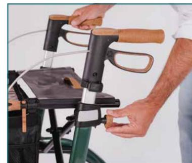
Öffnen Sie die Handschrauben an den Griffstangen. Auf der Innenseite der Stützholme finden Sie eine Höhenskala, mit deren Hilfe Sie die linke und rechte Griffstange leichter auf die gleiche Höhe einstellen können.
