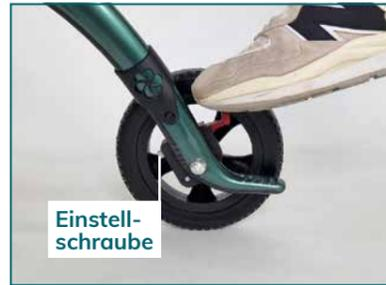
Die Nutzung der Schleifbremse empfiehlt sich bei leichtem Gefälle oder bei Menschen mit stark eingeschränktem Schrittempo. Betätigen Sie den roten Kipphel, um die Schleifbremse zu aktivieren. An der Einstellschraube können Sie den Rollwiderstand einstellen.
