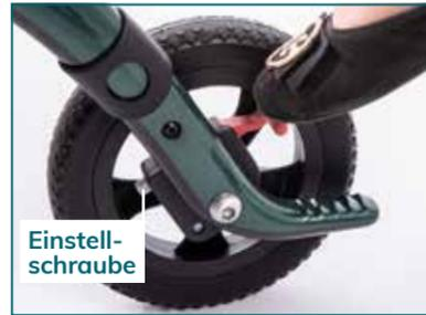
Betätigen Sie den roten Kipphebel, um die Schleifbremse zu aktivieren.
