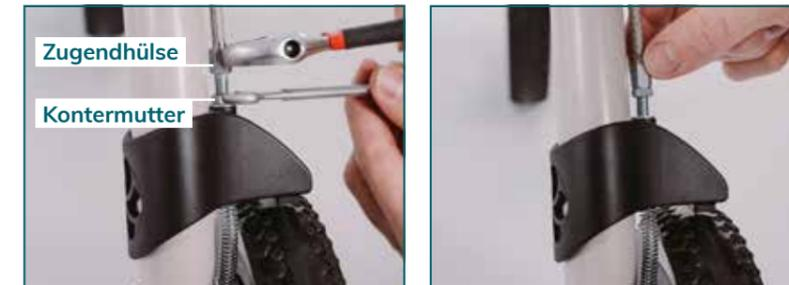
Kontermutter mit Gabelschlüssel Größe 8 lockern und komplett nach oben drehen. Die Zugendhülse gleichzeitig fixieren.
